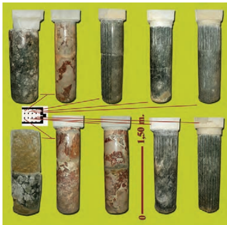
Figura 48. Composición en la que hemos aislado de su enclave las diez columnas romanas reutilizadas en la construcción de la mezquita del Castillo de San Marcos. El dibujo de la planta de la mezquita sitúa la ubicación de cada una.
