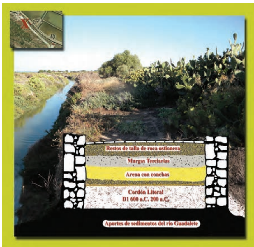
Figura 18. – La anchura del tramo junto a las salinas con un dibujo ideal de la sección de la calzada. A la izquierda (este) están los rellenos de sedimentos que forman la marisma del Guadalete; a la derecha (oeste) quedan las formaciones de dunas aportadas por el mar que forman el Manto Eólico Litoral, donde se ubica el pinar (desde 1634) y monte bajo del Coto de la Isleta. Arriba, su ubicación.
