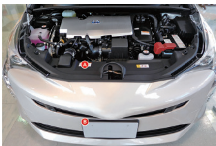
A ラジエータサポートオープニングカバー B フロントバンパーエクステンションマウンティング 自動車エンジンルーム部品 写真提供：いその(株)
