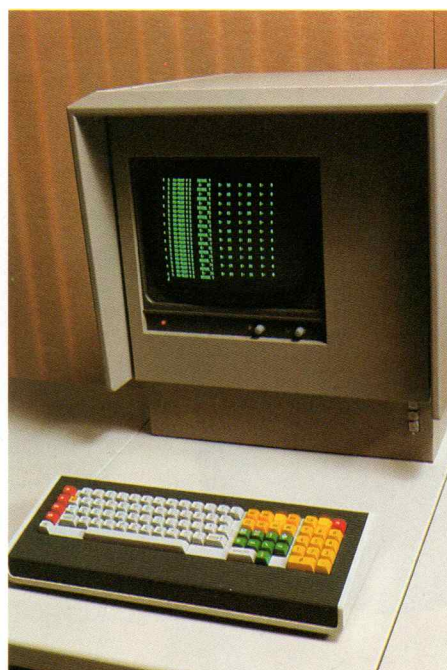
Bedientastatur und Datensichtgerät: Arbeitsschritte werden über den Monitor abgefragt, der Operator tastet daraufhin seine Befehle (z.B. Einzelbildabruf)
