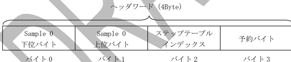
図 52 IMA-ADPCM 音声データのヘッダワード
