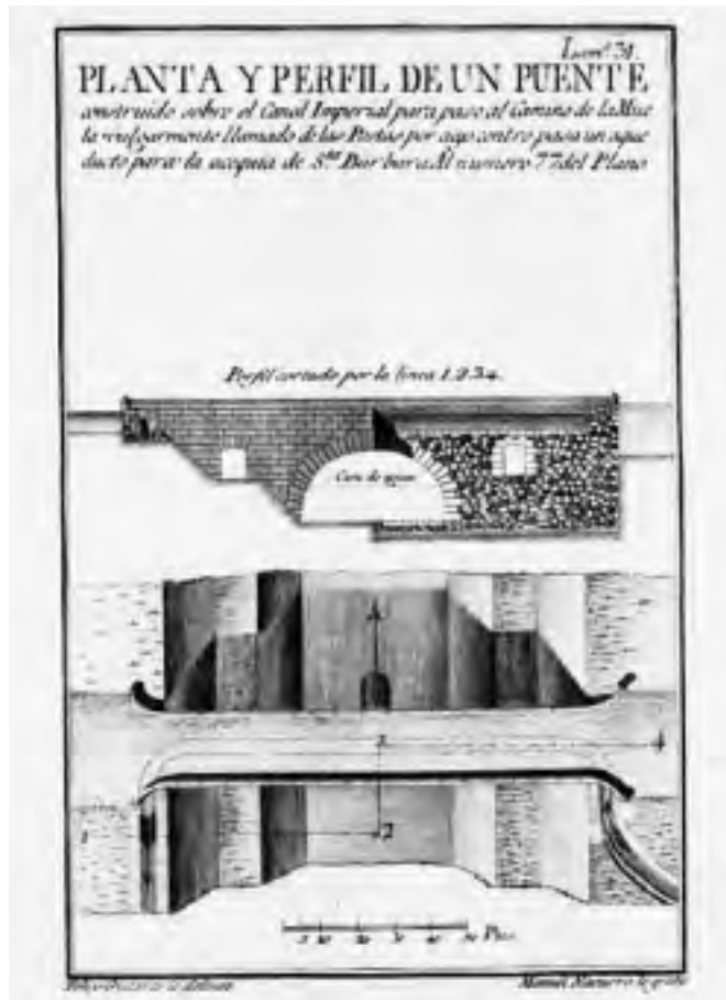
Planta y perfil del puente de La Muela, 1796. Descripción de los canales Imperial de Aragón y Real de Tauste
