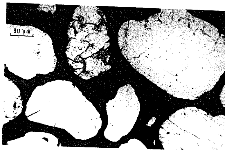
2. — Cimentation complète, sans porosité : les hydroxydes de fer cimentent solidement tous les grains et pénètrent dans les fissures des quartzites qu'ils peuvent dissocier (provenance Commensacq).
